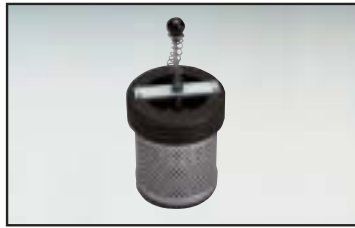
Suojaventtiili estää nostoletkun äkillisen ylös tempautumisen kuorman irrotessa. Asennetaan nostoletkun ja imupään väliin.
