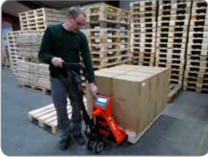
WSP 2200 - vaakavaunu kuljettaa ja punnitsee samalla kertaa.
