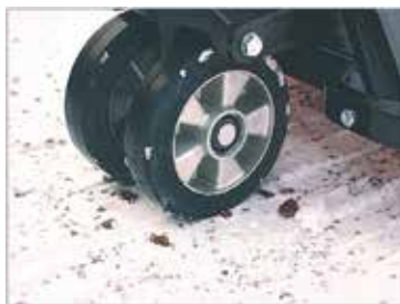
Lumi tarttuu tavallisen haarukkavaunun pyöriin.
